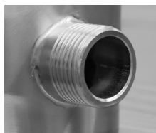
4 mm Wandstärke des Flachgewindes
